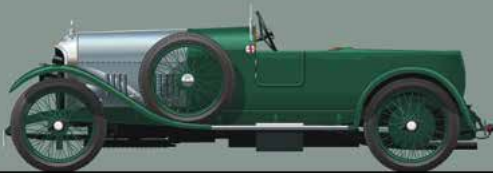
2-türiger 3-Sitzer Sport Tourer von Maule & Sons Motor Body Builders Chassis-Nr. 96 (2,99 m Radstand) 06.1922 an A. G. Gripper ausgeliefert
